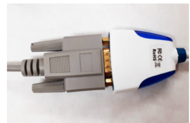
9-poliges Crossover-Kabel, das an den RS232-zu-USB-Konverter angeschlossen ist.
