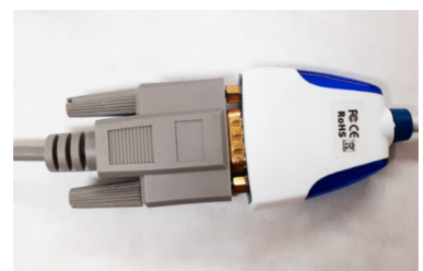
Kabel Crossover 9 Pin terpasang ke konverter RS232 ke USB.
